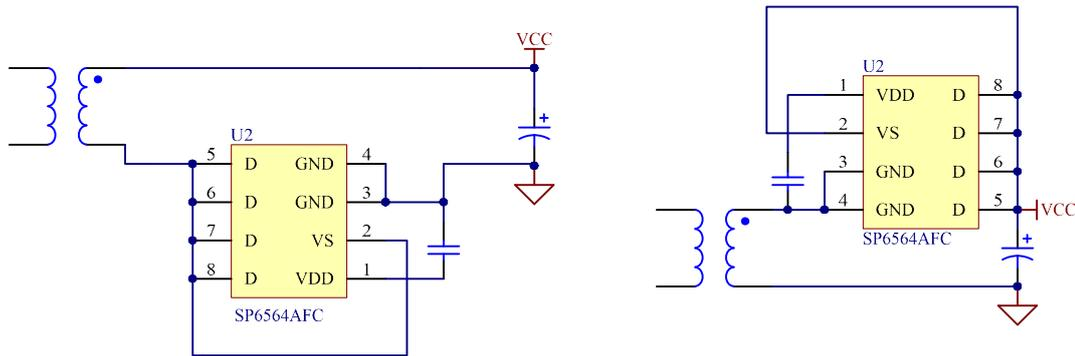
图 3 VDD 退偶电路
